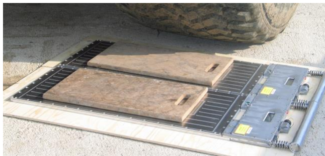
Fig. 12 : balance routière, société Haenni, type WL 103, surface sensible 66 x 38 cm.
